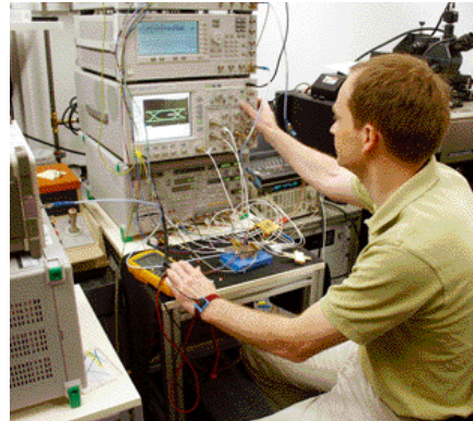
Christian Kromer von der ETHZ beim Ausmessen seines in IBM-gonm-CMOS-Technologie gebauten Datenempfängers am Bitfehler-Messplatz bei IBM. Im Bild (von oben nach unten): Clock Generatoren bis 20 GHz und 40 GHz, ein Sampling-Oszilloskop mit 50 GHz Bandbreite zur Anzeige der Daten, ein schneller Datengenerator mit vier 12,5 Gbps Kanälen und Multiplexer bis 40 Gbps. Im Hintergrund ein 300-mm-Waferprober. (Bild: Elsbeth Heinzelmann)
